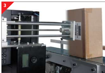
3 Souple - dépose d'étiquettes sur les différentes faces quel que soit l'angle requis.
